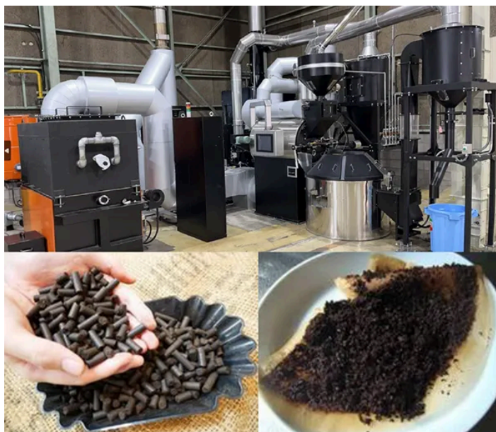
コーヒーグラウンズ（写真右下）を加工してペレット状の燃料（写真左下）にするグリーン焙煎機（写真上）
