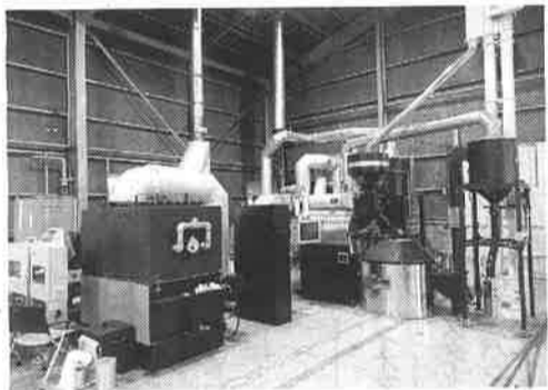
グリーン焙煎のために開発した30kgテスト焙煎機(写真奥)と燃焼炉
